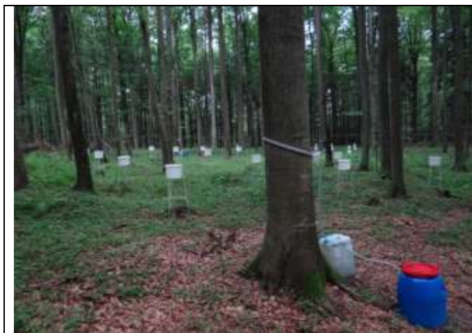
Fot. 5. Powierzchnia monitoringu chemizmu oraz ilości wód płynących po pniach (fot. P. Stachyra).
